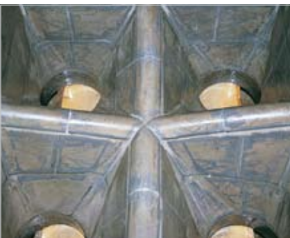
Trichter zum Materialaustrag in jeder Form werden mit ABRESIST Verschleißschutz versehen
