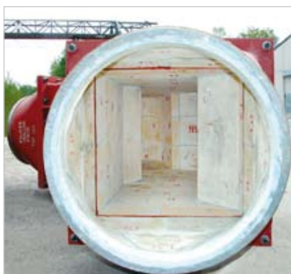
Kohlestaubverteiler mit sicherer KALCOR Panzerung für störungsfreien Dauerbetrieb
