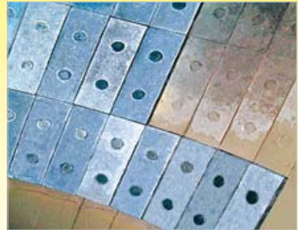
Panzerung einer Kohlestaubleitung mit Hartguss KALMETALL-C
