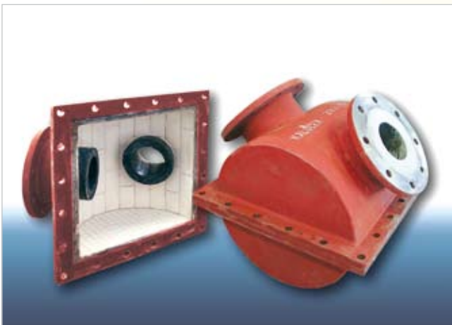
Kalenborner Umlenktopf mit ABRESIST und KALOCER, die besonders beanspruchten Teile sind auswechselbar
