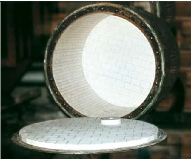
KALOCER Auskleidung einer Mühle zur Feinstmahlung von Farbpigmenten
