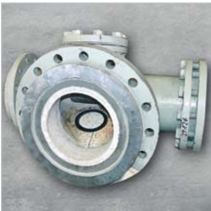
Rohrweiche in pneumatischer Förderleitung mit KALCOR
