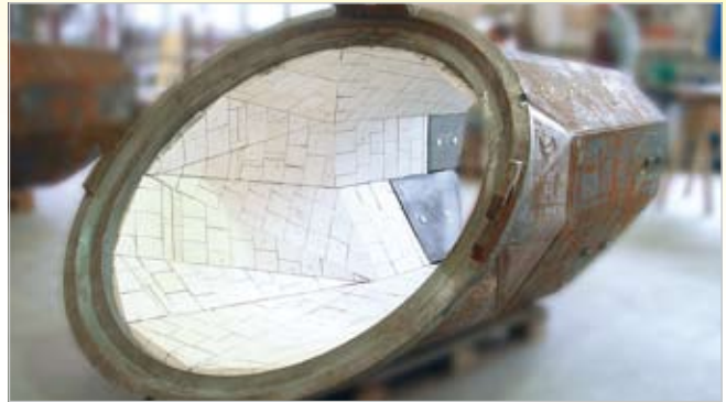
Achtecktrichter im Stahlwerk; die 50 mm dicken KALOCER Platten sind 3-dimensional geformt und geschnitten
