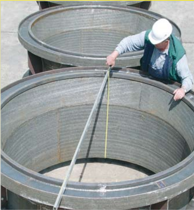
Abscheidkonen von Zementsichtern aus KALMETALL-W 100 als selbsttragende Konstruktion
