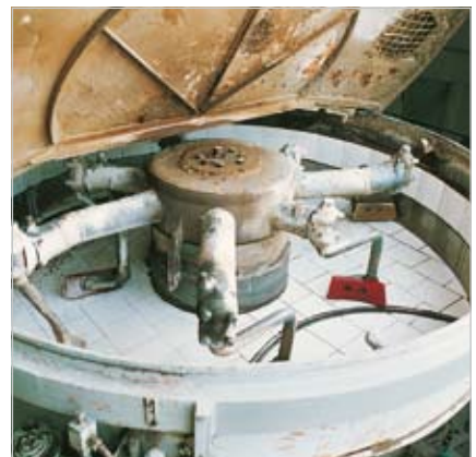
Hoch beanspruchte Rührwerke und Mischer lassen sich entsprechend der Konstruktion individuell mit KALOCER Platten dauerhaft schützen
