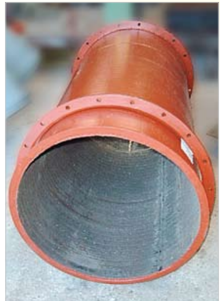
Mit KALMETALL-W 100 gepanzerte Rohrleitung im Einsatz eines Entstaubungssystems, der Innendurchmesser beträgt 400 mm, die Systemdicke 8 + 5 mm
