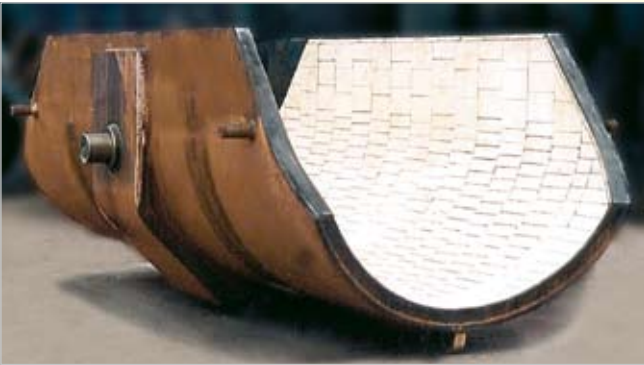
Schurre für die Hochofenzustellung in Europa, die KALOCER Auskleidung ist 50 mm dick
