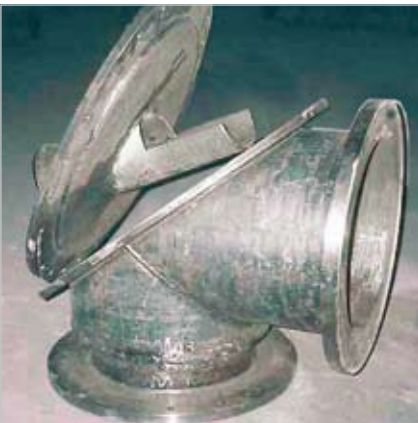
Kohlestaubbrenner mit Auskleidung aus KALMETALL-W 145
