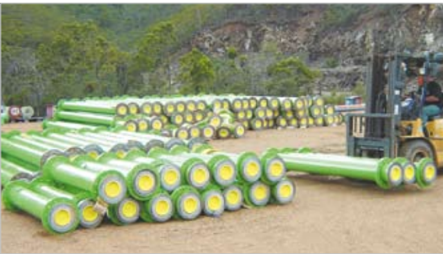
Hochverschleißfeste KALOCER Rohre für die Förderung von Erzschlamm in einer Mine im Fernen Osten
