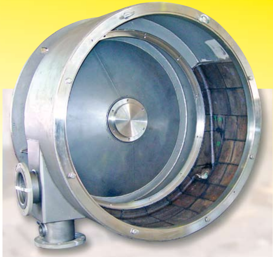
Kombisorter in der Papierindustrie aus Edelstahl, verschleißgeschützt mit Schmelzbasalt-Platten
