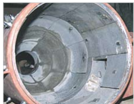
Zyklon in einer Bodenwaschanlage zur Reinigung von kontaminiertem Erdreich, wirksam geschützt mit KALMETALL-C
