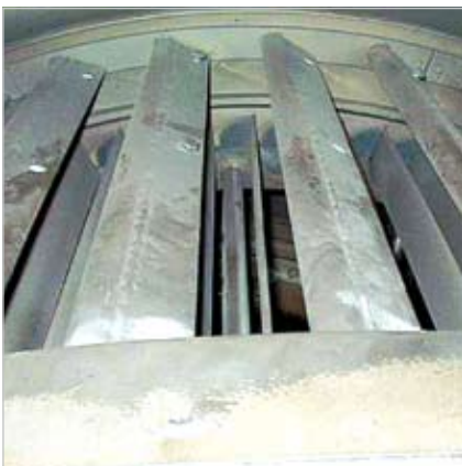
Leitschaufeln eines Sichters einer Kohlemühle aus KALSICA-A
