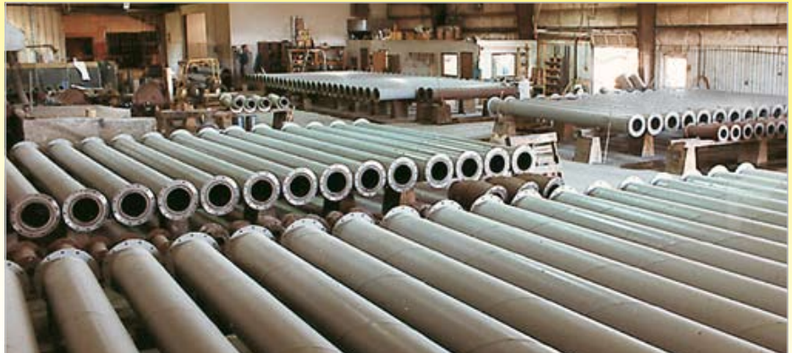
Hydraulische Ascheleitung bei der Herstellung im Werk der Abresist Corporation in Indiana, USA
