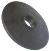
Stützscheiben auf Tragrollen überbrücken größere Distanzen zum Fördergurt. Sie stützen den Gurt und werden vorzugsweise bei Wellenkantengurten oder profilierten Fördergurten im Untertrum eingesetzt. In der Regel haben Stützringe eine konische Form und berühren den Gurt nur linienförmig.
