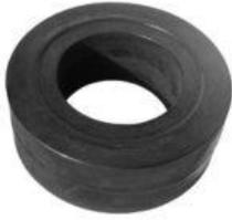
Mit Stützringen des B-Typs ausgestattete Tragrollen werden wie der A-Typ meist als Untergurtrollen eingesetzt. Aufgrund der hohen Belastung am Gurtrand sind die Stützringe des B-Typs zumeist am Tragrollenende platziert.
