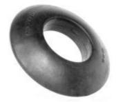
Stützringe vom Typ-A werden auf Tragrollen aufgezogen als Untergurtrollen eingesetzt. Der Stützring berührt den Gurt durch seine konische Form nur linienförmig. Dies verhindert ein Verkrusten und Aufbauen von Schmutz auf den Tragrollen und gewährleisten einen geraden Lauf im Untertrum.
