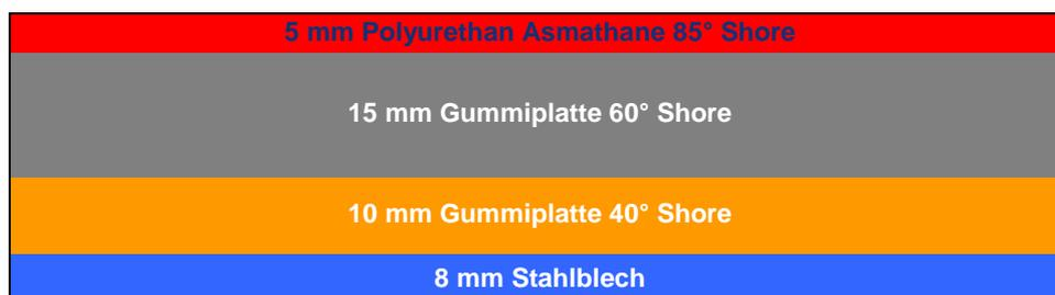
**Verbindung:** Die Verbindung der einzelnen Schichten erfolgt durch ein spezielles chemisch/physikalisches Verfahren nach entsprechender Vorbearbeitung der einzelnen Sandwichelemente in mehreren Arbeitsstufen, um eine dauerhafte Bindung der unterschiedlichen Materialien (Grundplatte, Dämpfungsschichten und Deckschicht) zu erreichen.
