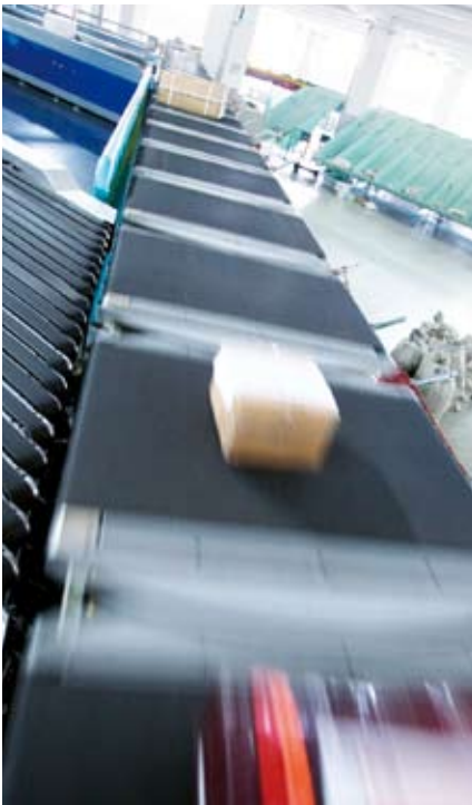
Quergurtsorter in einem Verteilzentrum. Die hohe Beschleunigung erfordert extrem gute Reibwerte der Bandoberfläche.
