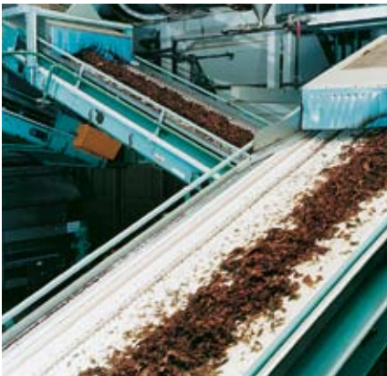
Schrägförderung in der Tabakindustrie. Bis zu einem Förderwinkel von 22° können in diesem Bereich auch Bandtypen mit glatten Oberflächen eingesetzt werden.
