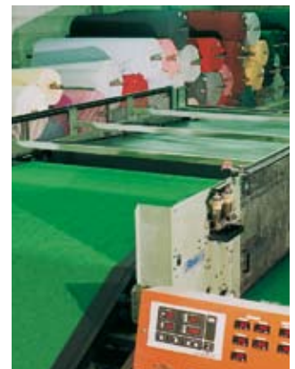
Kreuzlegen von Vlieslagen in der Nonwoven-Industrie. Hohe Produktionsgeschwindigkeit und Massenbeschleunigung – bei direkter Vliesführung zwischen den Bändern – stellen höchste Ansprüche an die eingesetzten Prozessbänder.
