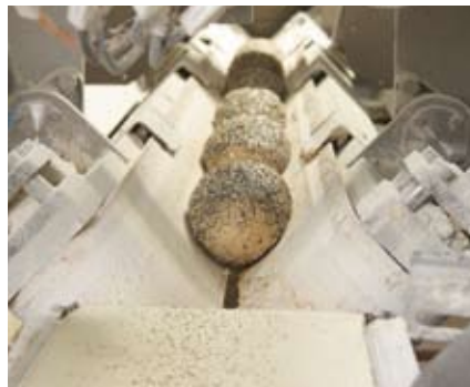
Durch unterschiedliche Bandgeschwindigkeiten werden in der Großbäckerei Rundlinge geformt.
