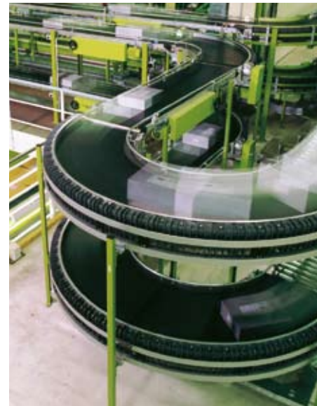
Kurvengurtförderer in einem Verteilzentrum.
