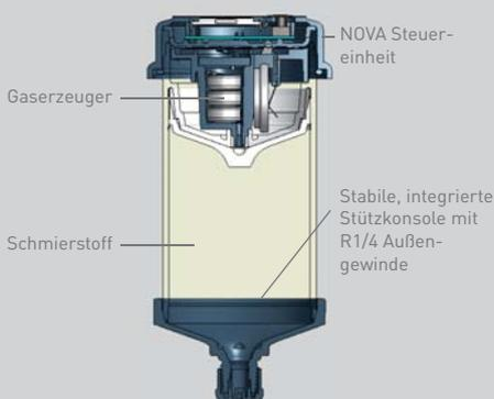
Ölbefüllte Einheit mit integriertem Ölrückhalteventil (rote Verschlusskappe)
