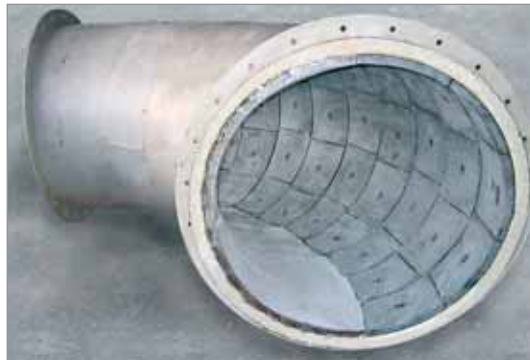
Einsatz in einer Schredderanlage für Kunststoffabfall: KALMETALL-C und KALCRET
