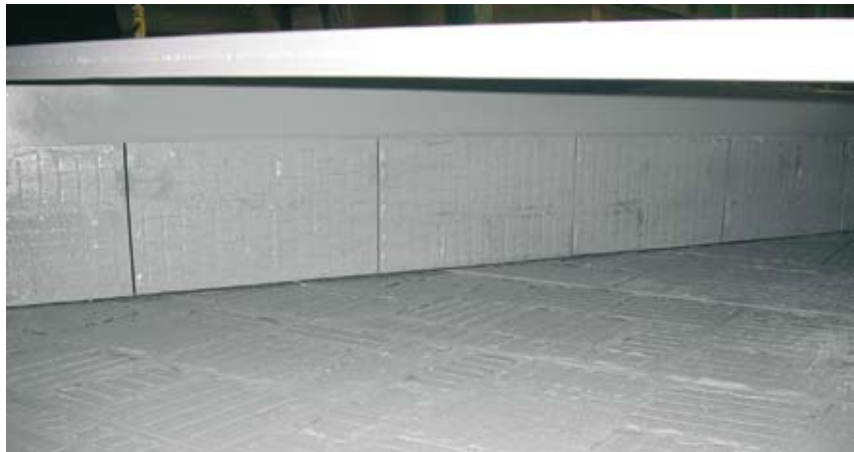
Passgenaue Einbringung der KERAFLEX-WRM Elemente in eine Rutsche; die max. Größe beträgt 500 x 500 mm; die Elemente können individuell angepasst werden
