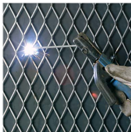
Anschweißen eines Rautengitters: Abstand ca. 250 mm
