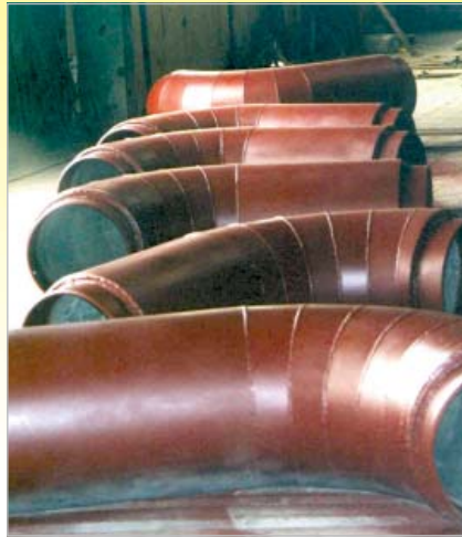
Kohlestaubbögen für ein Kraftwerk mit vorgefertigten Rohrbögen KALCRET
