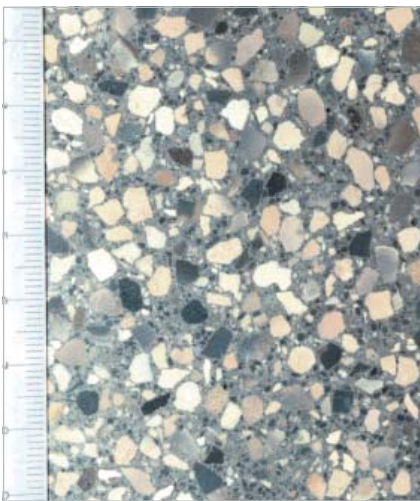
Gefügebau von KALCRET: hochfeste Zementmatrix, Hartstoffe 0,1 ... 4 mm (Bauxit oder Korund)
