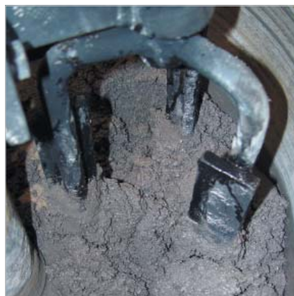
5. Die verarbeitungsfertige Masse weist eine plastische bzw. steif / plastische Konsistenz auf
