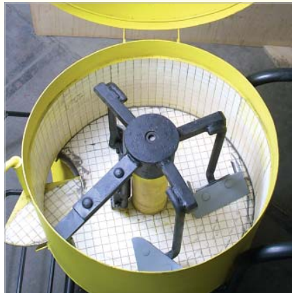
Verschleißgeschützter Mischbehälter eines Kalenborner Zwangsmischers
