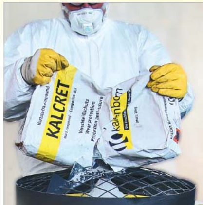
1. Hartstoffkomponente KALCRET in den Mischer aufgeben
