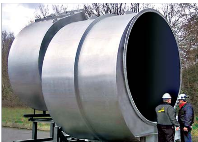
Wirkungsvoller Verschleißschutz bei großen Flächen
