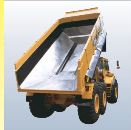
Im Bergbau werden vielfach verschleißgeschützte Muldenkipper eingesetzt
