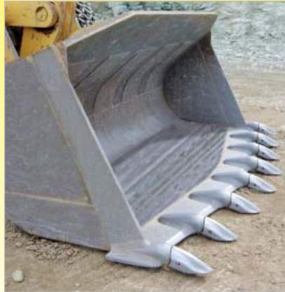
Bei Ladeschaufeln kommen auch Kombinationen mit Hartauftragschweißung KALMETALL-W zum Einsatz
