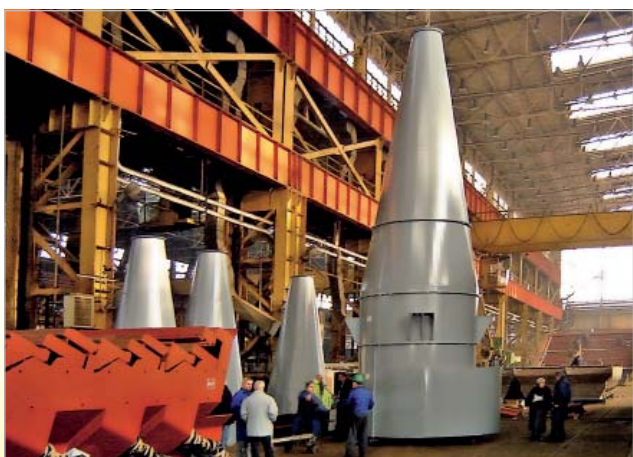
Entstaubungszyklone in selbsttragender Konstruktion
