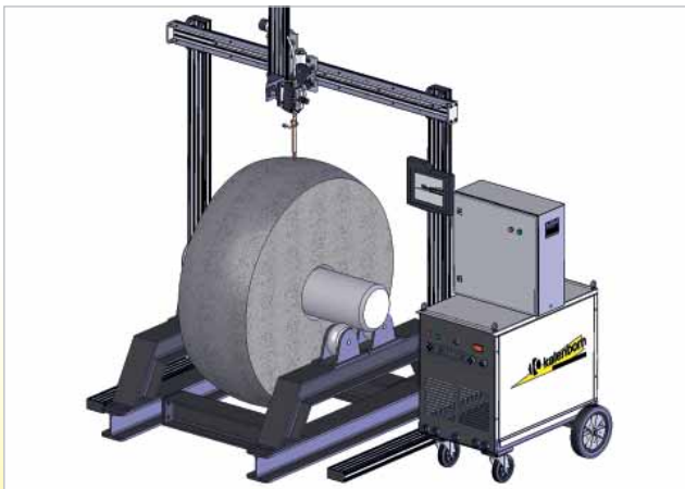
Kalenborner Schweißsysteme sind speziell für die Regenerierung von Mahlrollen und Mahltellern ausgelegt
