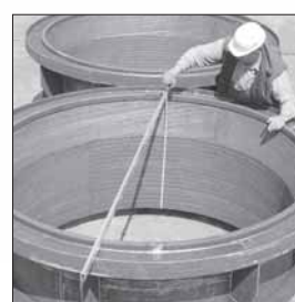
Abscheidekonen von Zementsichtern aus KALMETALL-W 100 6+4, Durchmesser 3 000 mm
