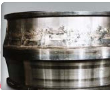
Durch Mangelschmierung verursachter Lagerschaden
