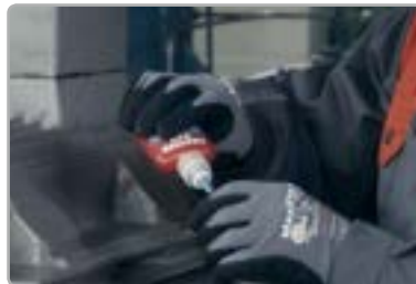
Gewindedichtmittel (z. B. Loctite® 243™) auf alle Anschlussstücke auftragen, Reduzierstück einschrauben
