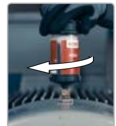
Schmier-system in die Schmier-stelle eindre-hen
