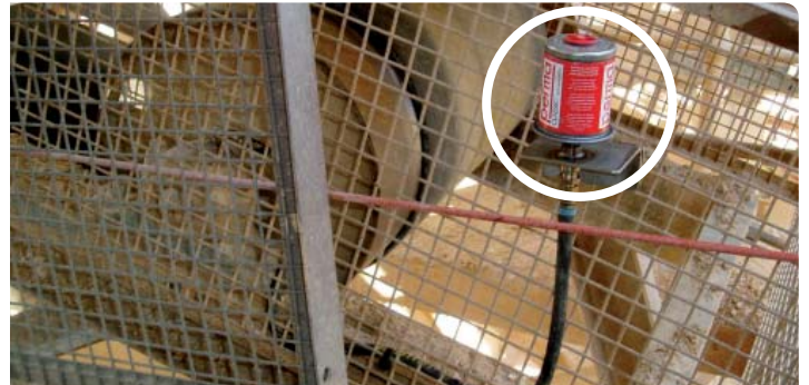
Lagerschmierung an einer Förderband-Antriebsstrommel. Durch die entfernte Montage des perma CLASSIC Schmierstoffgebers ist ein sicherer Wechsel auch bei laufender Anlage ohne Werkzeug möglich.
