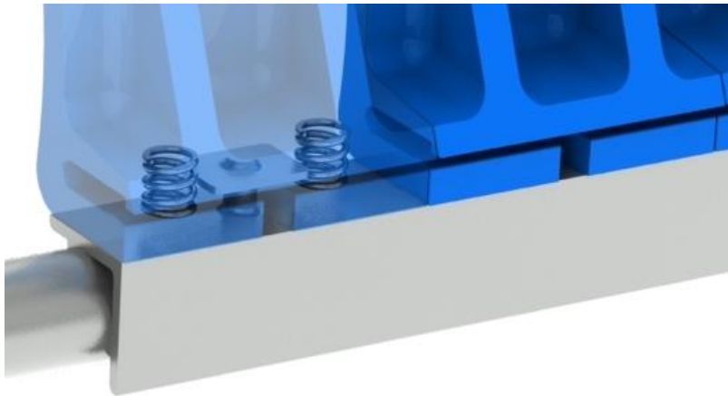
Einfache durchgehende Lamellen können sich nicht anpassen
