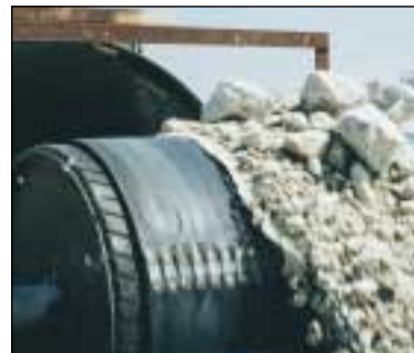
Nr. 3, unser größter Verbinder, für Bänder ab 24 mm Bandstärke.
