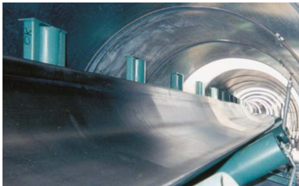
Mit Ladung oder im Leerlauf: die Gurtposition ist nahezu dieselbe.
